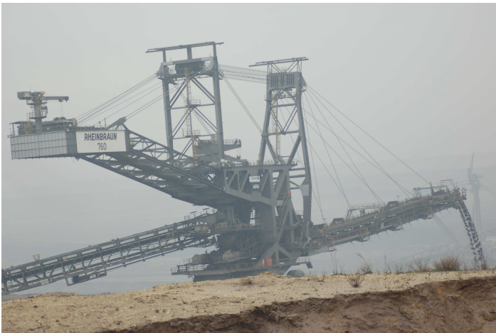
Foto 2: „Absetzer“ im Tagebau Garzweiler (Foto: M. Jung)
