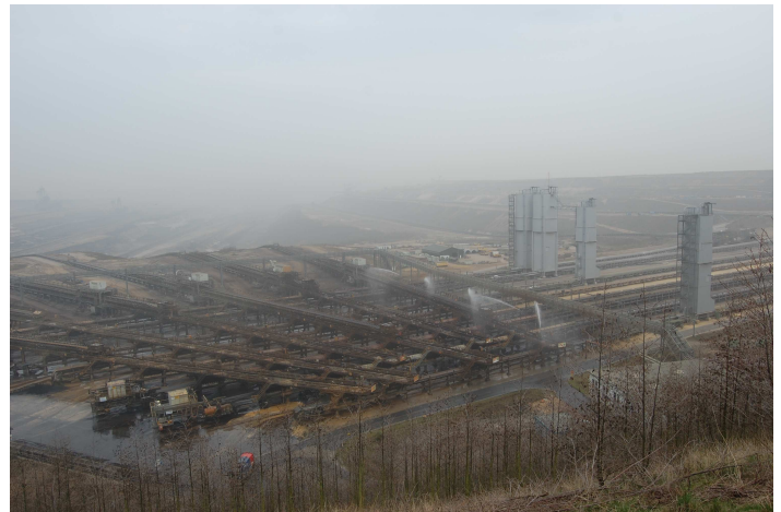
Foto 3: Förderbandanlage für Kohle und Abraum (Foto: M. Jung)
